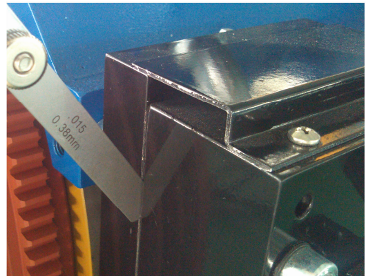
图 7 塞尺检测静板和动板气隙
